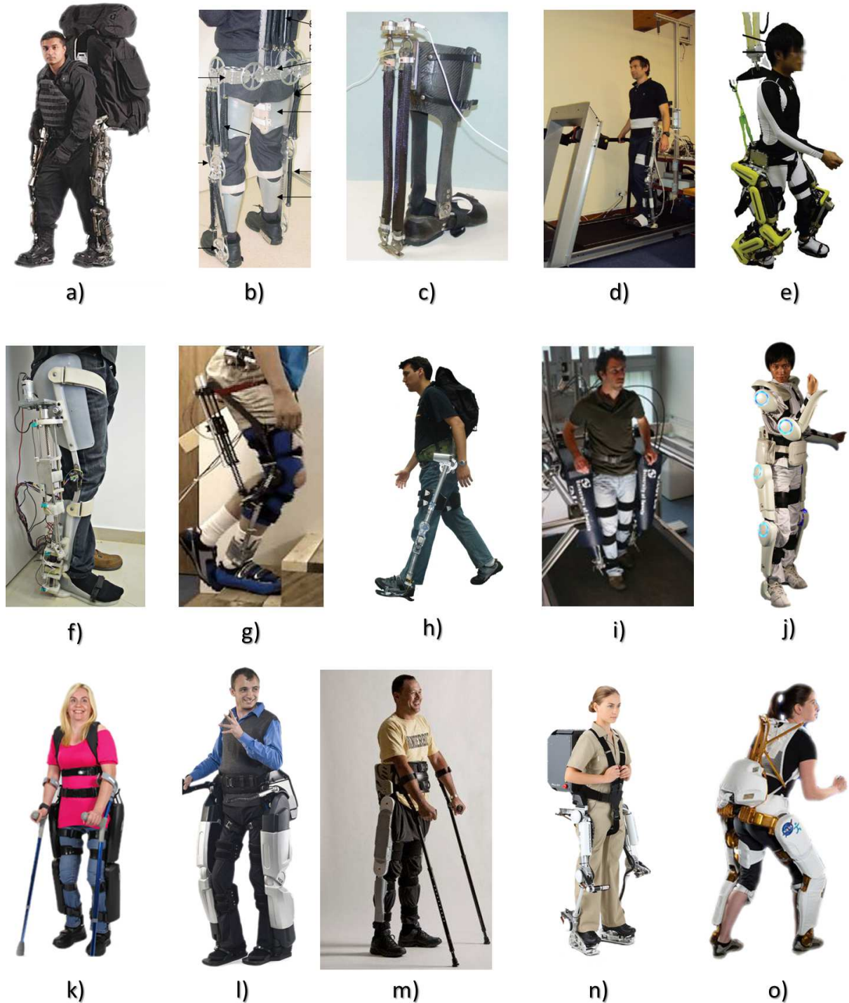
Figura 1.5: Exoesqueletos para el aumento de fuerza: a) BLEEX [16], [17], b) Soft-actuated 10 DoF Lower Body Exoskeleton [21], c) Actuated orthosis [22], d) Robotic orthosis [23], e) XoR [25], f) ELLTIO exoskeleton [20], g) RoboKnee [15], h) MIT exoskeleton [?], i) LOPES [32], j) HAL5 [18], k) ReWalk [26], l) Rex exoskeleton [31], m) Indego exoskeleton [28], n) Power Loader [29], o) NASA X1 exoskeleton [30].
