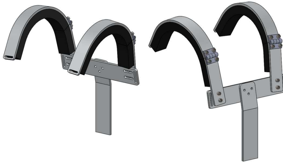
Figura 3.9: Propuesta de diseño para el arnés que sujeta el tórax al resto del robot.
